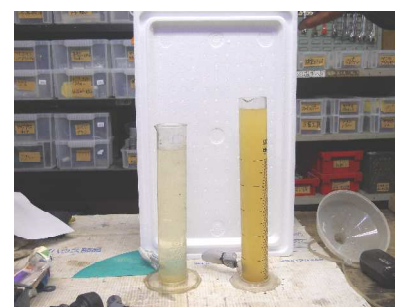
濾過後の状況 右: 原水 左: 濾過水
